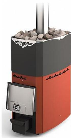
Печь Новая Русь 18 ЛУ с укороченным топливным каналом устанавливается и топится непосредственно из парной. Помимо особой атмосферы в парной, такая печь ускоряет воздухообмен в парной, забирая отработанный воздух для горения дров, и дополняя лёгкий пар свежестью приточного воздуха.
