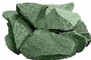
Камни для банных печей представляют собой горные породы, обладающие высокой жаропрочностью. Они обладают оптимальной теплоёмкостью для создания комфортного микроклимата при парении в бане.
