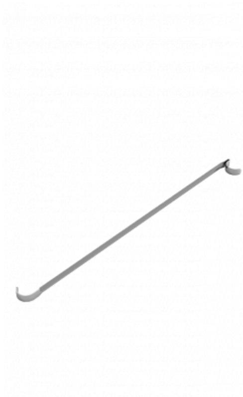
Кочерга ПРО с лёгкостью прочистит даже самые дальние трубы водотрубного теплообменника. Чистку водотрубного теплообменника котла нужно производить после прогорания топлива, пока теплоноситель в системе горячий. Одним концом кочерги можно очистить заднюю поверхность труб теплообменника, другим – переднюю.
