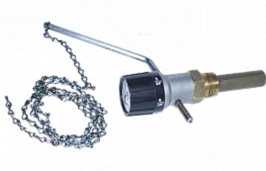
Встроенный термостат измеряет температуру теплоносителя. Является комплектующим для отопительного котла "Куппер". В соответствии с настройками при помощи рычага с цепью контролирует подачу воздуха в топку, открывая или закрывая воздушную заслонку в нижней дверце "Куппера".
